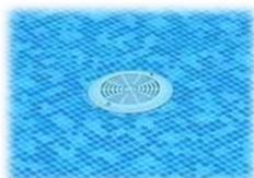
**Bouche d'aspiration ou de refoulement :** Dispositif incorporé à la paroi ou au fond du bassin, destiné à aspirer ou refouler une partie de l'eau du bassin.
